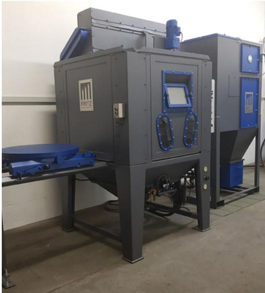
Die günstige Form und die Größe der Kabinen der 1100er Serie machen diese Standardtypen durch die vielfältigen Einbaumöglichkeiten von technischen Zusatzausrüstungen, durch den Einbau mehrerer und bei Bedarf oszillierender Strahldüsen sowie durch Integration in kundenseitig vorhandene Förder-systeme zum Basismodell für automatisch arbeitende Injektorstrahlanlagen.
