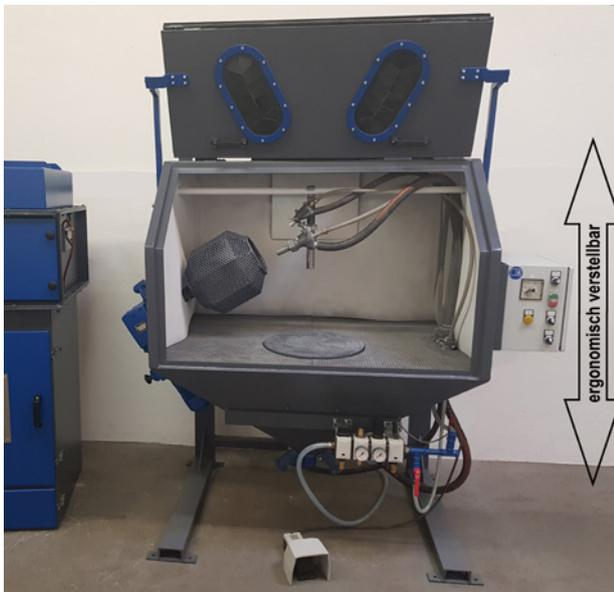
Statt der sternförmig geschlitzten, mehrlagigen Gummimanschetten können auf Wunsch auch fest eingebaute 5-Fingergummihandschuhe geliefert werden.
